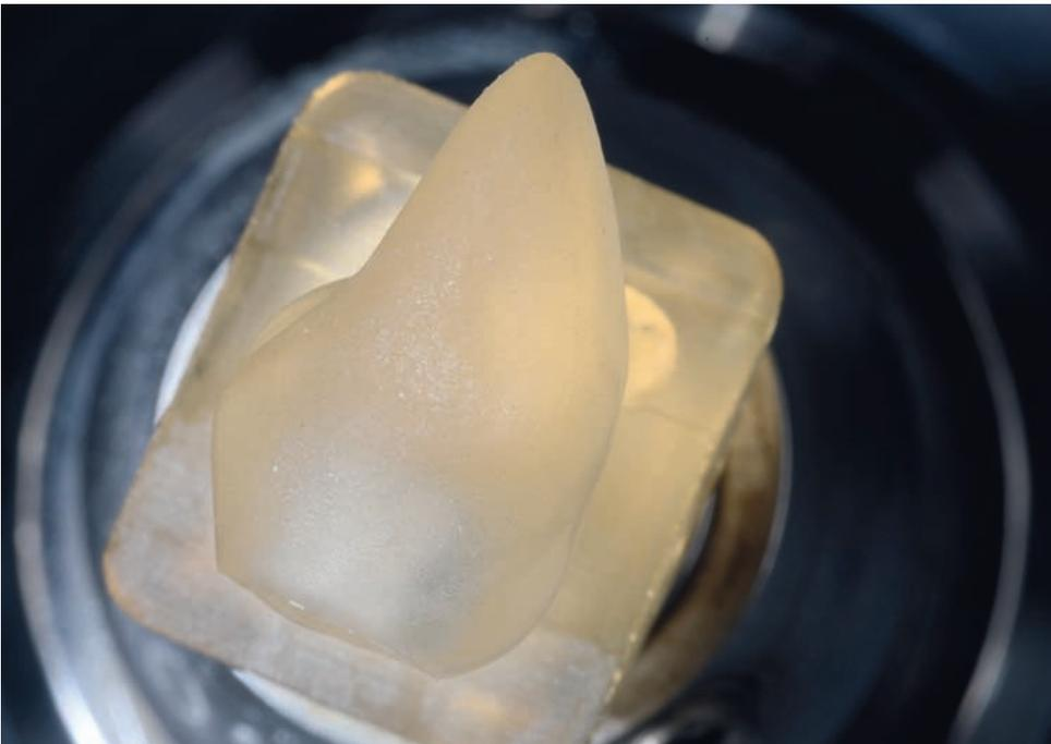
Abb. 10: Auf Basis des ebenfalls eingescannten Wax-ups lässt sich im CAD/CAM-Verfahren die zunächst vollanatomische Krone fräsen. Werkstoff ist eine zirkoniumdioxidverströkte Lithiumsilikat-Keramik (Vita Suprinity).
